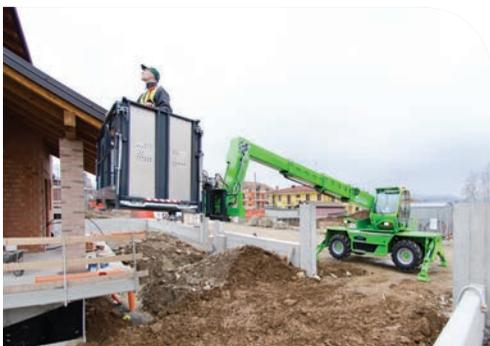
Der ROTO 40.18 S ist das neueste Mitglied der um 400° drehbaren ROTOs von Merlo. Er wurde konzipiert für größtmögliche Leistung bei gleichzeitig kompakter Bauweise. Ausgestattet mit automatischer Abstützung und gefederten Achsen, verspricht er Benutzerfreundlichkeit und vielseitige Einsatzmöglichkeiten. Egal ob im Materialumschlag oder dem Einsatz mit Arbeitsbühne.
